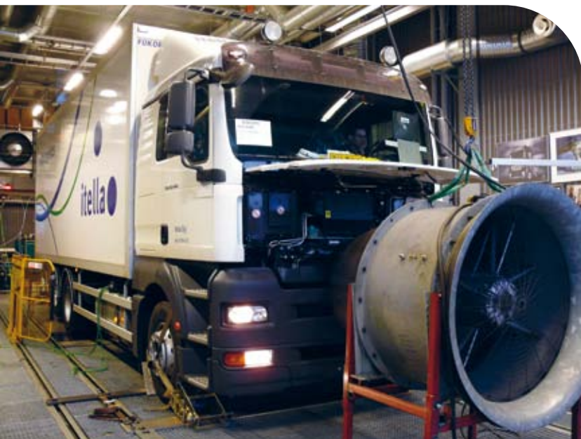
VTT:n kehittämä mittaamenetelmä paljasti eri automalleilla huomattavia eroja polttoaineen kulutuksessa ja päästöissä.
